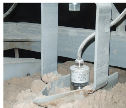
Рис. 3. Измерение влажности материала на транспортной ленте
