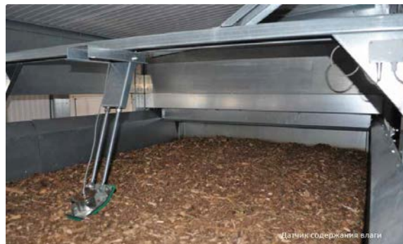
Рис. 51. Сушка древесной стружки на ленточном сите ленточной сушилки
