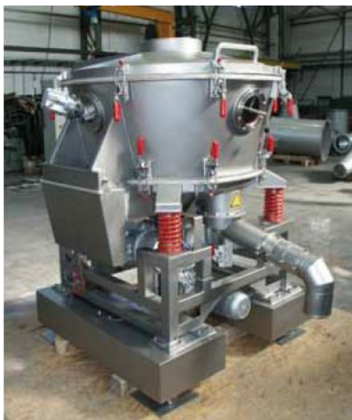
Рис. 99. Вибросушилка периодического действия: а ) общий вид, б ) схема сушилки
