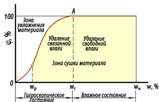
Рис. 4. Изменение влажности материала в процессе сушки.
